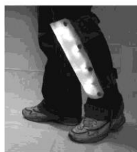
2010年，美国加州大学圣巴巴拉分校设计团队开发了一款名为《腿灯》的便携式照明设备。它采用LED光源，通过腿部佩戴的方式进行照明，具有体积小、重量轻、续航时间长等特点。该产品在户外活动中具有广泛的应用前景。
