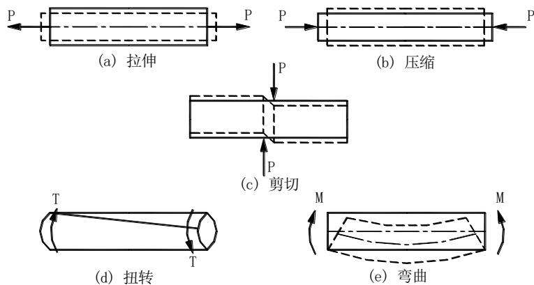
(1) 轴向拉伸或轴向压缩 在一对大小相等、方向相反、作用线与杆轴线重合的外力作用下，杆件将发生伸长或缩短变形，这种变形形式称为轴向拉伸或轴向压缩。其受力特性为外力的作用线与杆件的轴线重合。变形特征为杆件沿轴线方向伸长或缩短。
