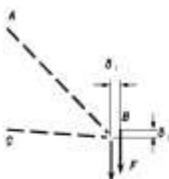
**变形：**在外力作用下，固体内各点相对位置的改变。(宏观上看就是物体尺寸和形状的改变)
