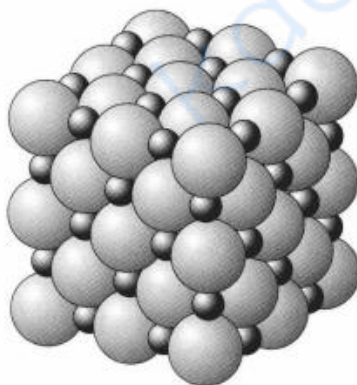
图 2.1 NaCl 的晶体结构 大球— \text{Cl}^- ，小球— \text{Na}^+
